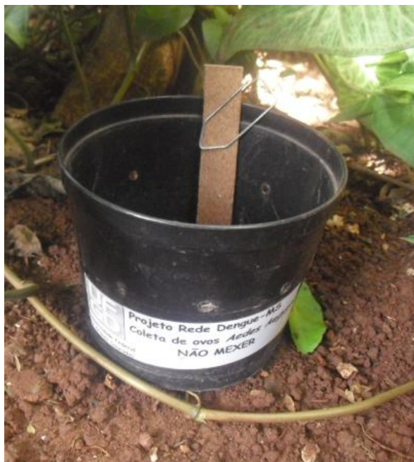
Figura 5. Armadilha de oviposição (modificada) utilizada na coleta de ovos de Ae. aegypti .
