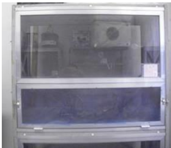
Figura 14. Gaiolas construídas de armação de alumínio e acrílico, usadas na criação dos mosquitos.
